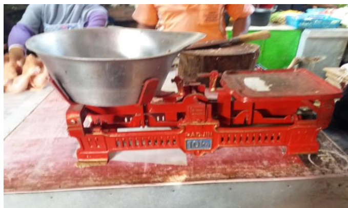
Gambar 4.7 Timbangan pedagang pertama yang penyetel nol nya tidak berfungsi dengan benar (seharusnya timbangan setimbang/sama rata)
