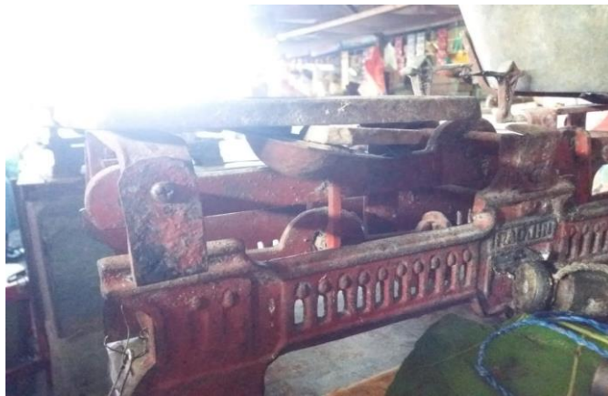
Gambar 4.8 Timbangan pedagang kedua yang penyetel nol nya tidak berfungsi dengan benar (seharusnya timbangan setimbang/sama rata)
