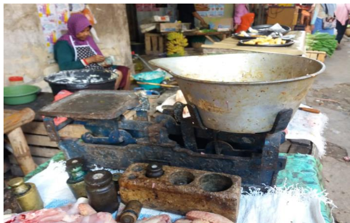
Gambar 4.10 Timbangan pedagang keempat yang penyetel nol nya tidak berfungsi dengan benar (seharusnya timbangan setimbang/sama rata)
