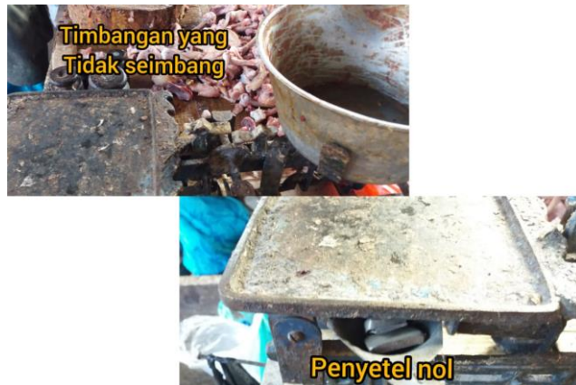
Gambar 4.9 Timbangan pedagang ketiga yang penyetel nol nya tidak berfungsi dengan benar (seharusnya timbangan setimbang/sama rata)
