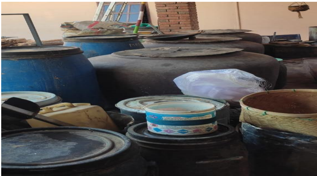
Gentong Untuk Perendaman Pembuatan Batik Gentongan
